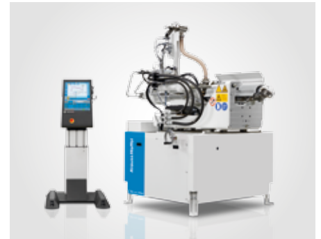
Die seitliche Spritzenanordnung (L) eignet sich für die meisten Einsatzzwecke. Die autarken Einheiten lassen sich einfach an Spritzgießmaschinen andocken.
