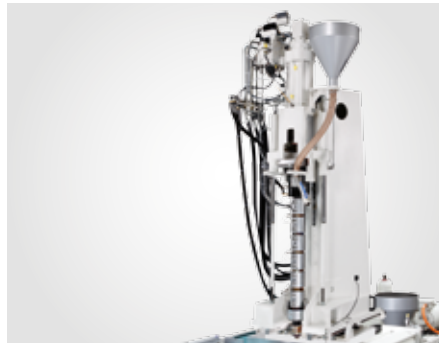
Die vertikale Spritzenanordnung (V) bietet sich an, wenn wenig Produktionsfläche zwischen den Spritzgießmaschinen vorhanden ist.
