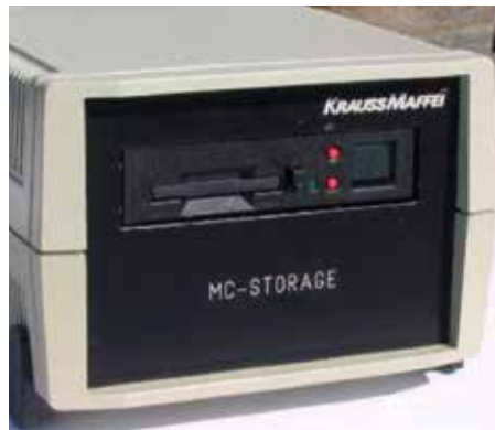
CF-Laufwerk integriert in MC-Storage für MC2-Steuerungen
